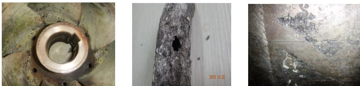
图 3 部件腐蚀穿孔
