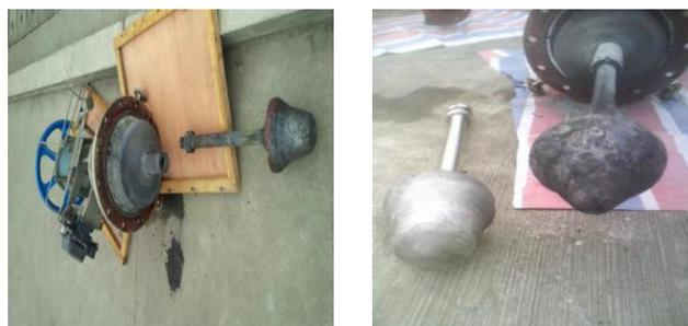
图5 阀芯腐蚀情况
