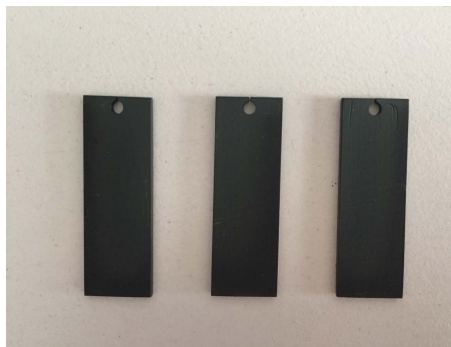
图 3 DD5+Al 涂层去除/再涂覆后 1100 °C 热冲击试验 2016 次外观
