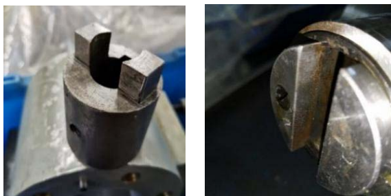
图 2 右机联轴套端面键及键槽磨损情况
