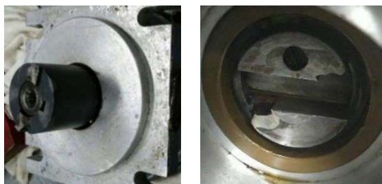
图 1 左机联轴套端面键及键槽磨损情况
