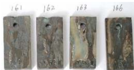
图 9 生产井井底 13Cr 管材试样腐蚀实验后 (清洗后) 表面宏观形貌
