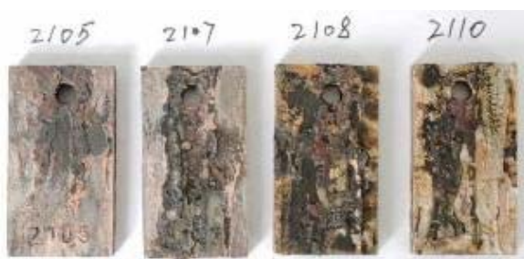
图 7 生产井井底 3Cr 管材试样腐蚀实验后 (清洗后) 表面宏观形貌
