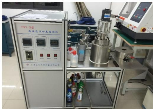
图 3 高温高压动态腐蚀测试仪
