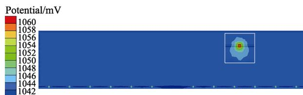
图 4 只有一个阳极失去作用时电位分布数值模拟云图
