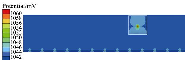
图 2 所有阳极均正常工作时电位分布数值模拟云图
