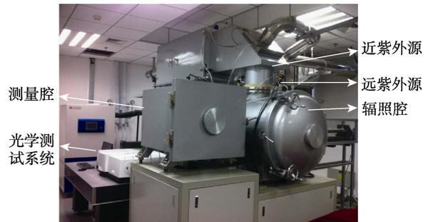
图6 高加速紫外辐照试验装置
