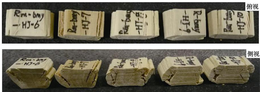
图 7 横纹径向压缩变形情况
