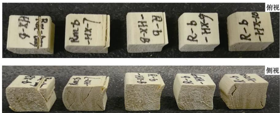
图 8 横纹弦向压缩变形情况
