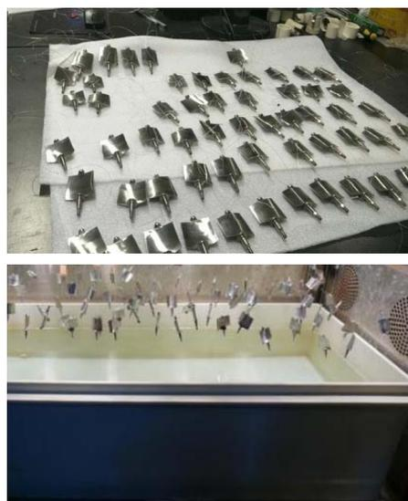
图 5 叶片试件分组及试验放置
