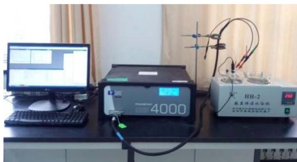
图 3 电化学试验装置
