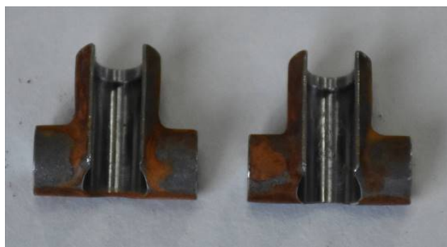
图 6 螺栓套盐雾试验 192 h 后照片
