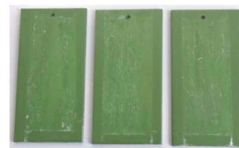
c 0Cr18Ni9+TW-7 无机漆酸性盐雾 192 h
