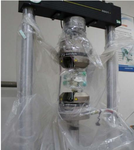
图4 腐蚀疲劳试验过程
