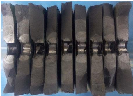
a 腐蚀-腐蚀疲劳试验断口整体照片
