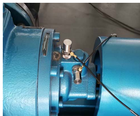
图 5 联轴器端传感器布置
