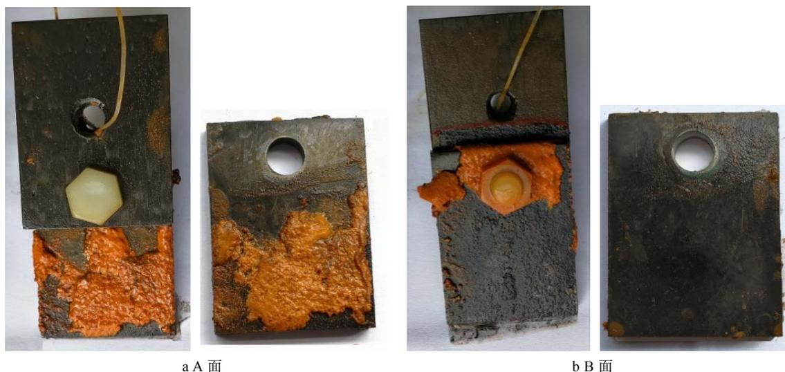
图3 CF-S电偶对试样2个表面的腐蚀形貌
