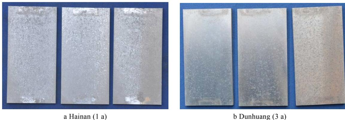
图3 7B50-T77511 铝合金在典型大气环境中的宏观腐蚀形貌
