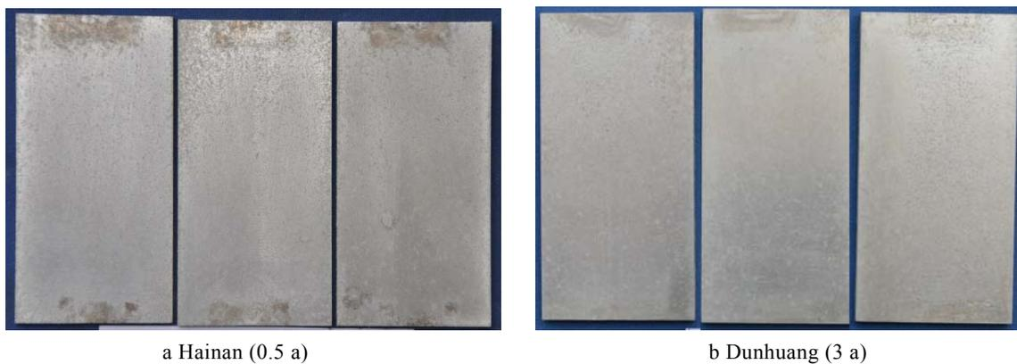
图2 7B50-T7751 铝合金在典型大气环境中的宏观腐蚀形貌
