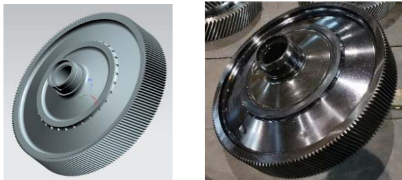
图 3 大齿轮组件表面氧化浸油前后对比
