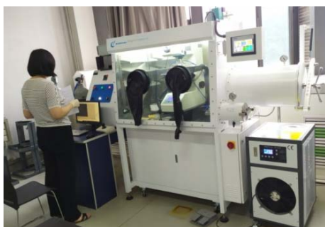
图2 HTV-PHS30 高温维氏硬度计 Fig.2 High temperature Vickers hardness tester
