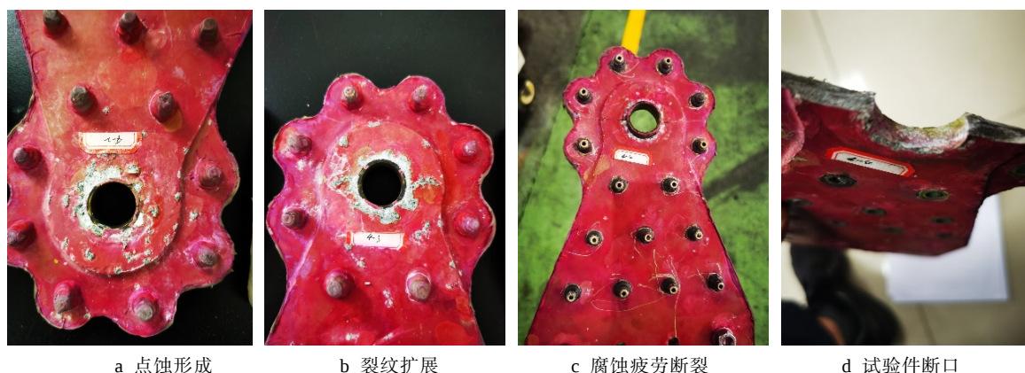
图 5 试验件的腐蚀疲劳断裂
