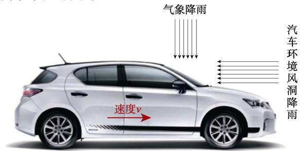
图 6 汽车行驶时气象降雨与汽车环境风洞降雨
