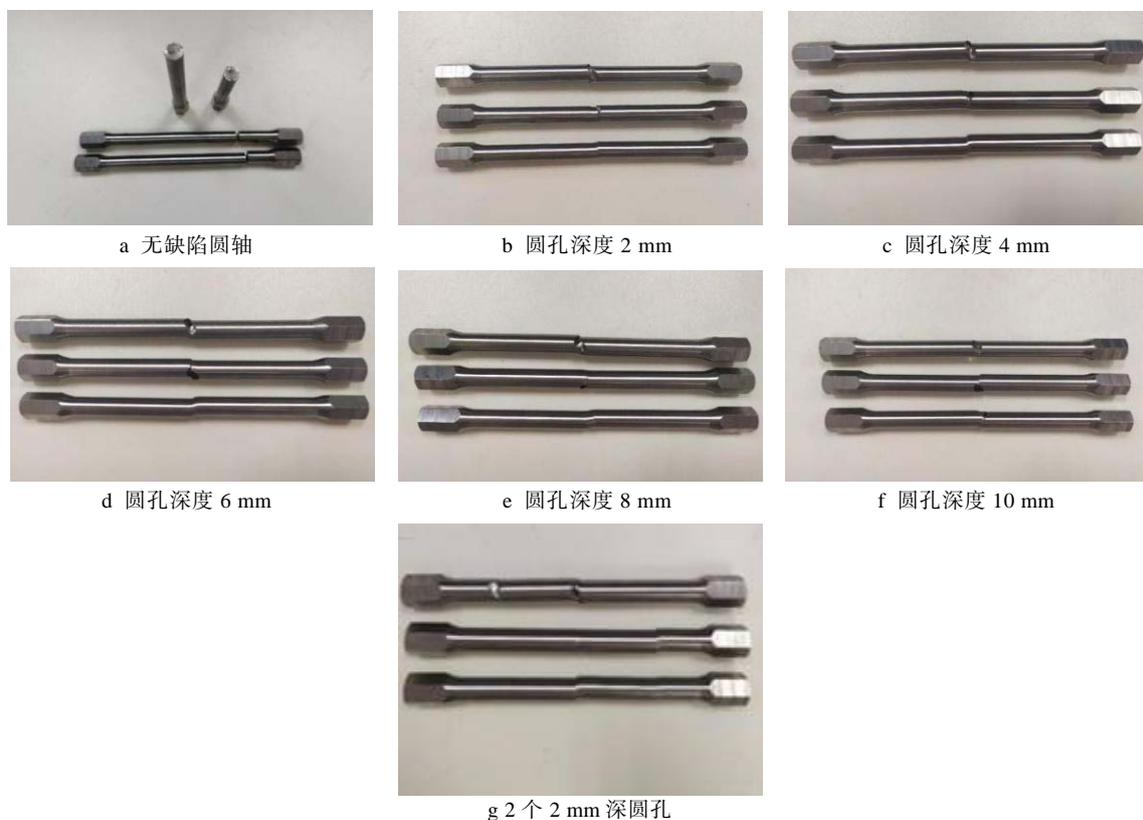
图 2  $\phi 10 \text{ mm} \times 100 \text{ mm}$  不同孔深圆轴试样扭转失效结果
