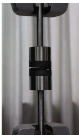
图 2 界面法向黏结强度试验
