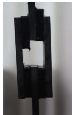
图 4 界面切向黏结强度试验
