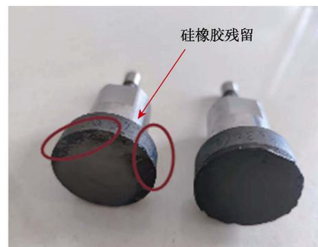
图 7 复合硅橡胶与铁氧体的界面法向破坏现象
