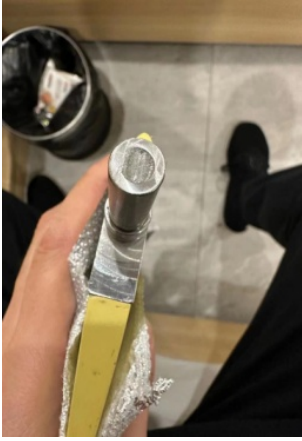
图 1 轴头断裂失效
