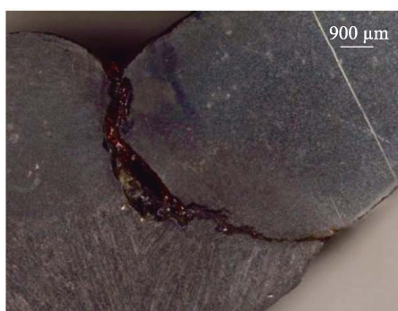
a 焊缝中的裂纹缺陷
